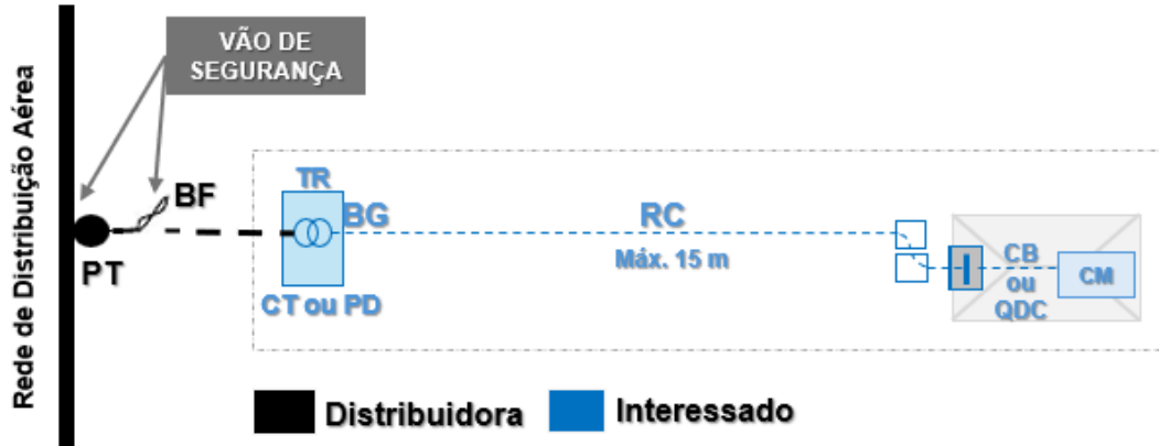
Figura 3 – Vão de Segurança em Rede Aérea Condomínio Vertical (EMUC)
